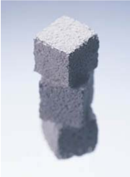
Figura 2 OSferion® implante tridimensional en base a fosfato tricálcico \beta ( \beta -TCP) con porosidades de 100–500 \mu\text{m} .
