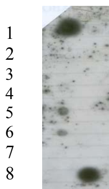
Figura 4. Estudio de interferencia de la muestra. Línea 1: Control positivo; Línea 2: PBS; Línea 3,: agua; Línea 4: control del medio; Línea 5: Dilución 10^{-5} UFC/mL; línea 6: Dilución 10^{-4} UFC/mL; Línea 7: Control negativo; Línea 8: Control positivo
